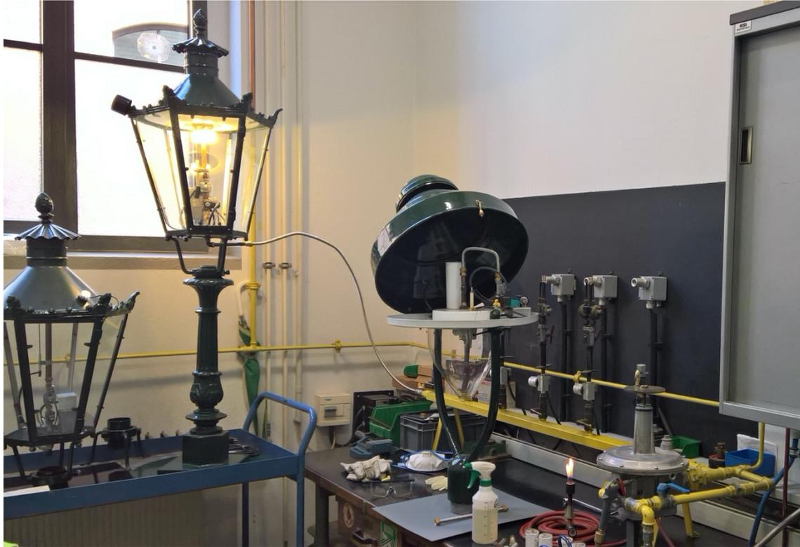
Stadtwerke Düsseldorf, Prüfstand für Gaslaternen in der Gaslichtwerkstatt
