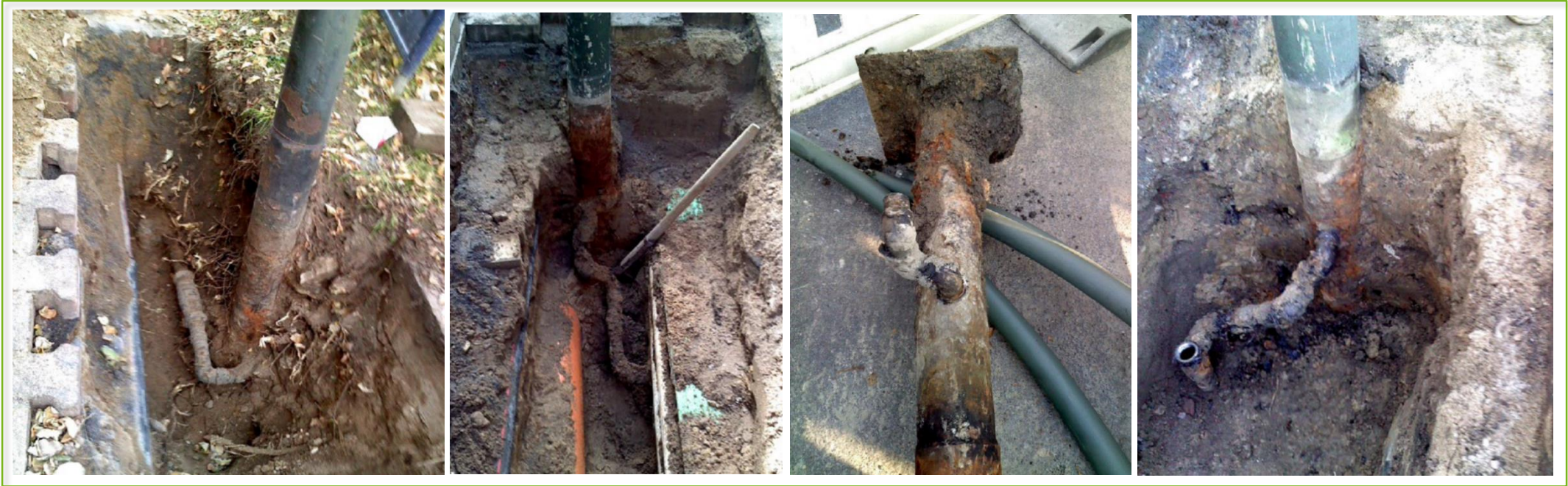
Korrosion Gasanschlussleitung
